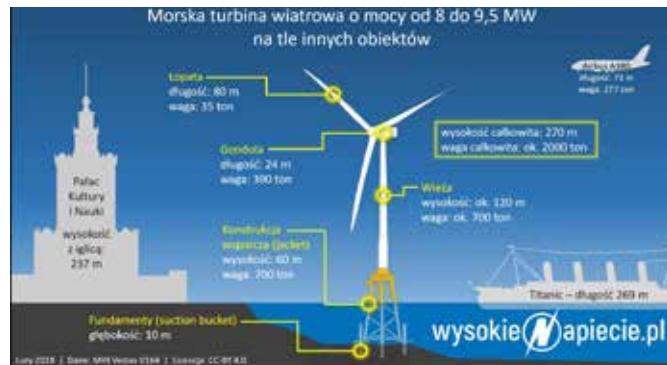
Rys. 3. Porównanie masy i gabarytów turbiny wiatrowej MHI Vestas o mocy 8-9,5 MW z innymi obiektami [10]
