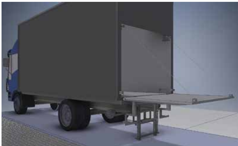
Rys. 5. Model windy pneumatycznej zamontowanej w ciężarówce Iveco Eurocargo 80E
