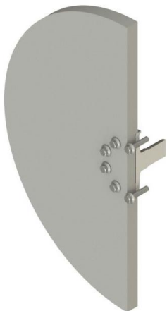
Rys. 7. Przekrój modelu koła zamachowego symulującego masę samochodu
