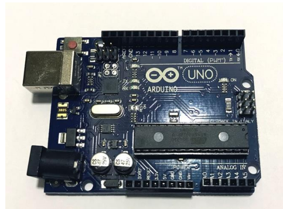
Rys. 2. Platforma Arduino UNO R3 zastosowana w projekcie. [fot. E. Sadowski]
