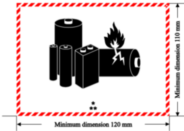
Rys. 5. Etykieta baterii litowych (Lithium Battery Mark -ważna od 1 stycznia 2017 r.)* miejsce na numer(y) UN, ** miejsce na numer telefonu, pod którym można uzyskać dodatkowe informacje [1]
