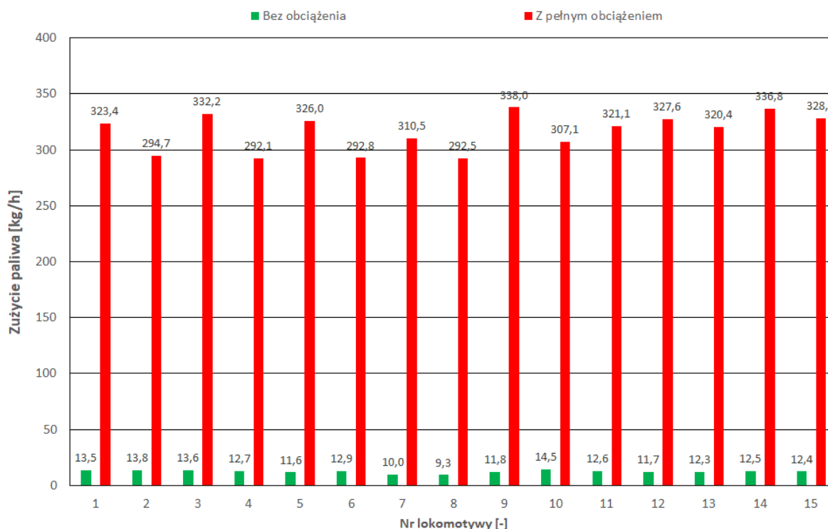
Rys. 7. Porównanie energochłonności pracy lokomotyw typu ST44 – pomiary z obciążeniem silnika (12CzN26/26) oraz bez obciążenia
