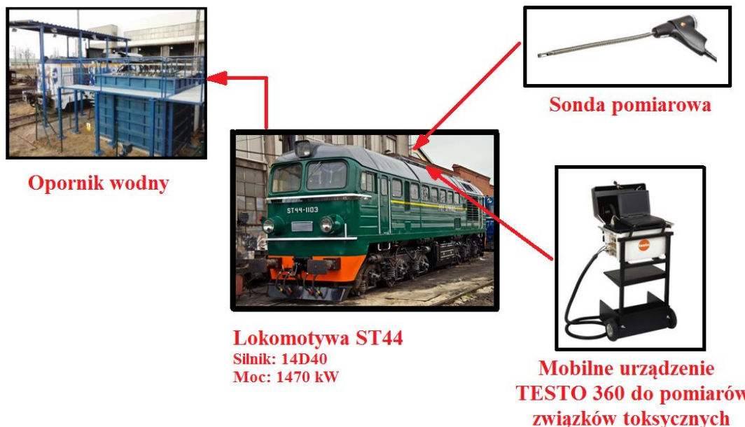
Rys. 3. Przykładowy obiekt podczas badań mobilną aparaturą do pomiarów toksyczności spalin na oporniku wodnym [1]
