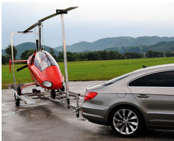
Rys. 1. Transport drogowy wiatrakowca produkcji Trixy Aviation z Austrii [27]
