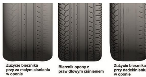
Rys.8. Zużycie opon w zależności od ciśnienia [7]
