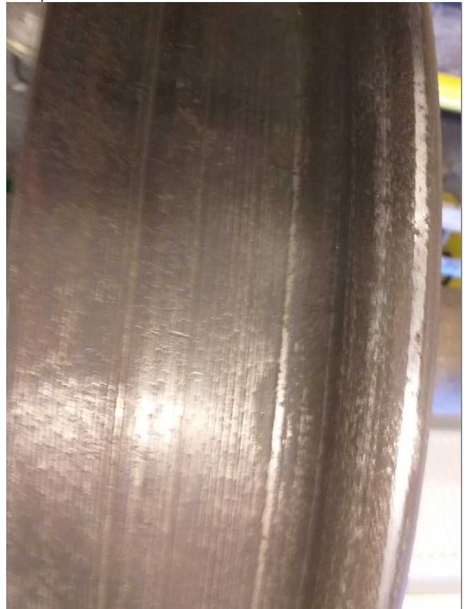
Rys.1. Powierzchnie toczne kół wagonowych: a – prawidłowo zużyte, b – nierównomiernie zużyte.
